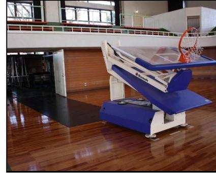
③プラエイドの上で移動式バスケット台を移動させ設置してください。使用後は同じ手順で元の場所に戻してください。
